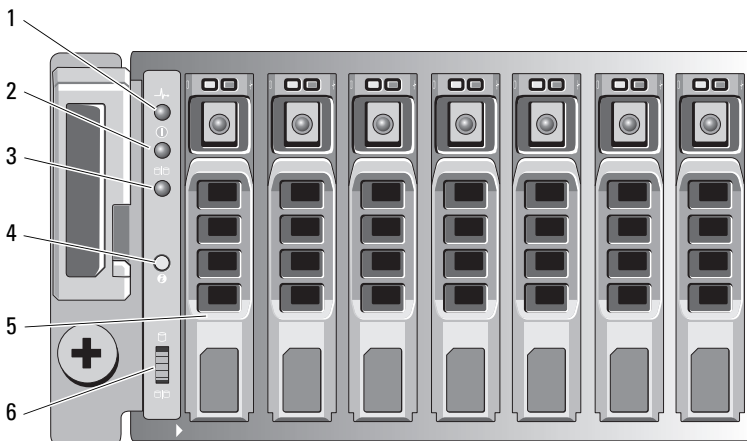
Figure 1-2. Fonctions et voyants du panneau avant — Dell PowerVault MD1200
